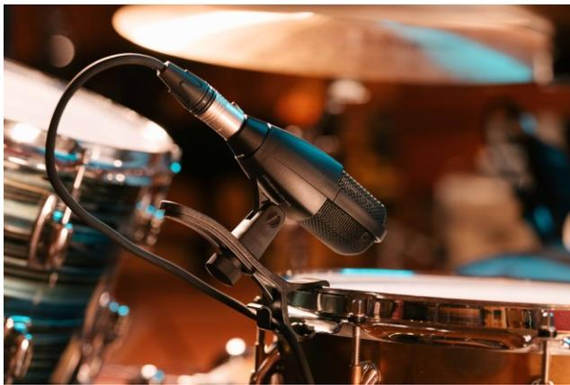
La versión para batería del MD 421 Kompakt incluye una pinza para batería que se enrosca de forma segura en el clip de micrófono rediseñado: un mecanismo a prueba de fallos para la microfonía de batería.
